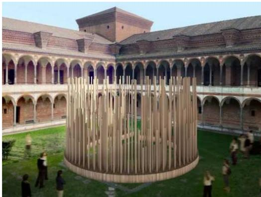
**Radura, di Stefano Boeri Architetti.** Un circolo di 350 colonne cilindriche in legno del diametro di 10 cm, il perimetro di uno spazio di sosta all'interno del cortile della Farmacia. Uno spazio in mezzo alla città, in mezzo a una foresta architettonica, realizzata completamente con il legno proveniente da Friuli Venezia Giulia.
